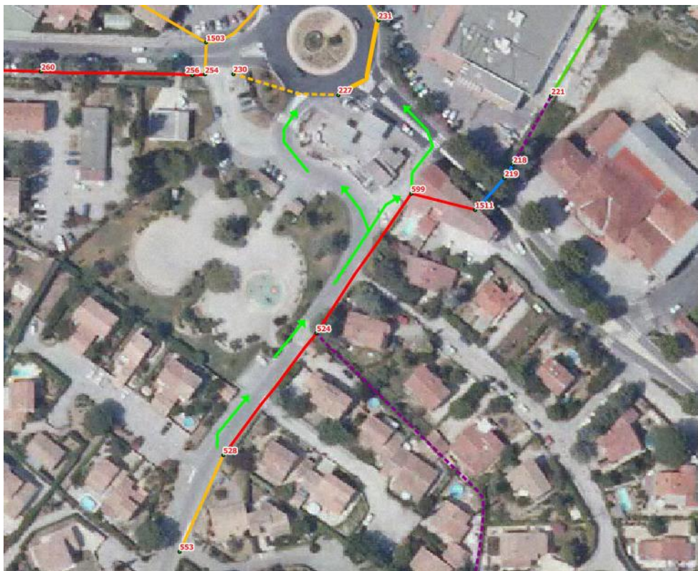
Insuffisance du réseau pluvial et sens d'écoulement des débordements (vert) – rue Antoine Simoni et écoulements vers le rond-point Pompidou
