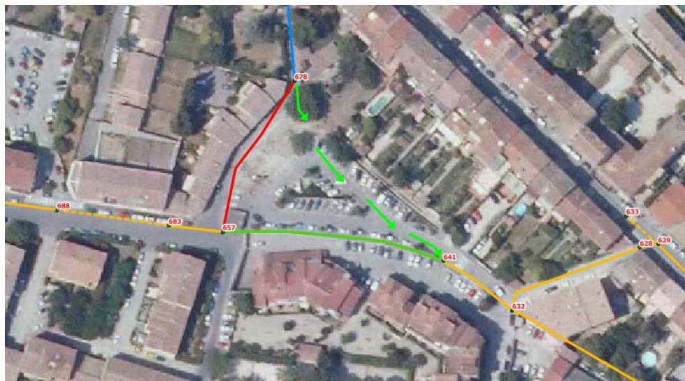
Insuffisance du réseau pluvial et sens d'écoulement des débordements (vert) – rue de la Font Neuve et rue Saint-Eutrope
