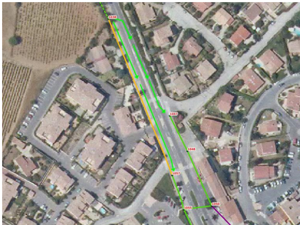
Insuffisance du réseau pluvial et sens d'écoulement des débordements (vert) – Avenue de la 1 ère armée
